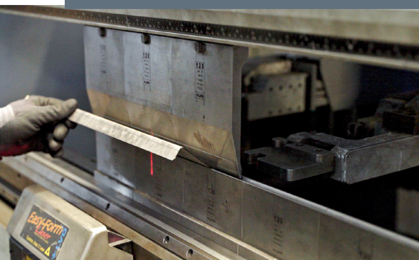
EasyForm Laser è la tecnologia di controllo angolo adattiva sviluppata da LVD che permette di adeguare i parametri di lavorazione in real time al fine di ottenere sempre l'angolo desiderato
