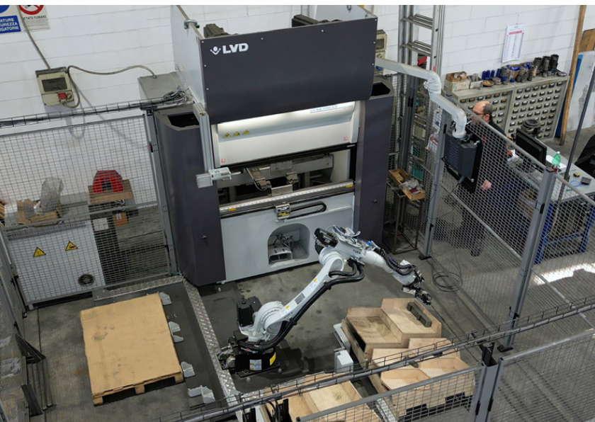
Con un ingombro di soli 5x5 m e in grado di avviare la produzione in soli 20 minuti, Dyna-Cell è la risposta automatizzata alla necessità di ICM di incrementare la produttività per realizzare i lotti più numerosi
