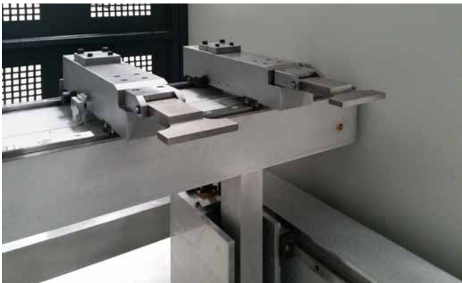
Butée arrière standard à deux axes (X, R) avec axe Z manuel sur PPEB-4 et PPEB-5
