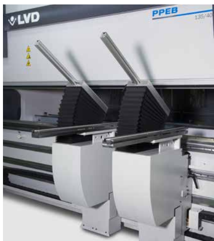
Deux supports de tôle programmables
