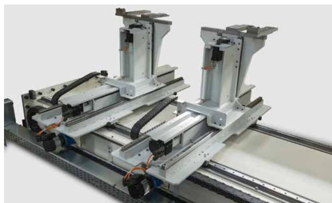
Registro posteriore modulare (X1, R1, Z1 - X2, R2, Z2) per 500 T e 640 T su PPEB-8
