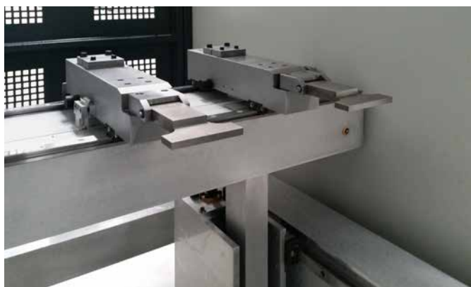
Registro posteriore standard a due assi (X, R) con asse Z manuale su PPEB-4 e PPEB-5
