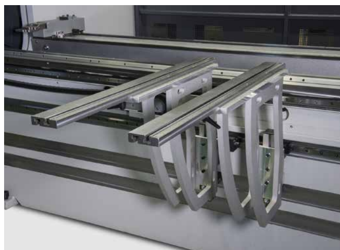
Voorsteunen op geleiderails voor een snelle positionering over de hele plooilengte
