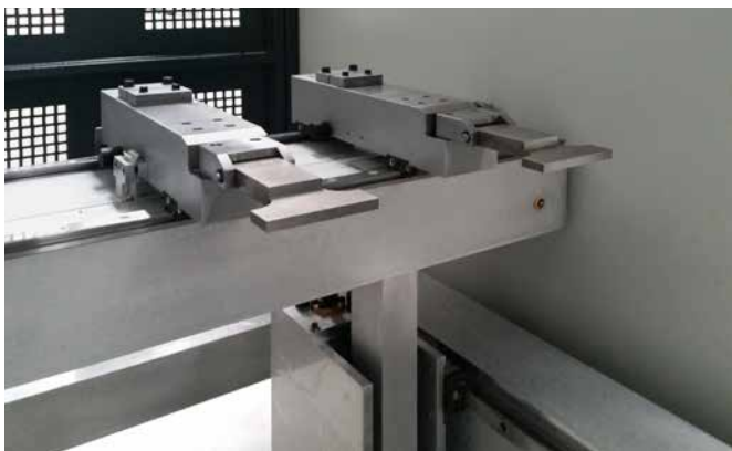
Standardowy dwuosiowy zderzak tylny (X, R) z ręcznym ustawianiem w osi Z w prasach PPEB-4 i PPEB-5
