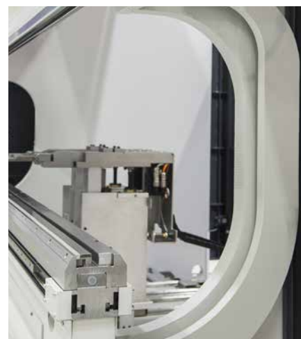
Zwiększanie odległości stół-suwak/skoku/ wysięgu kolumn w krokach co 100 mm
