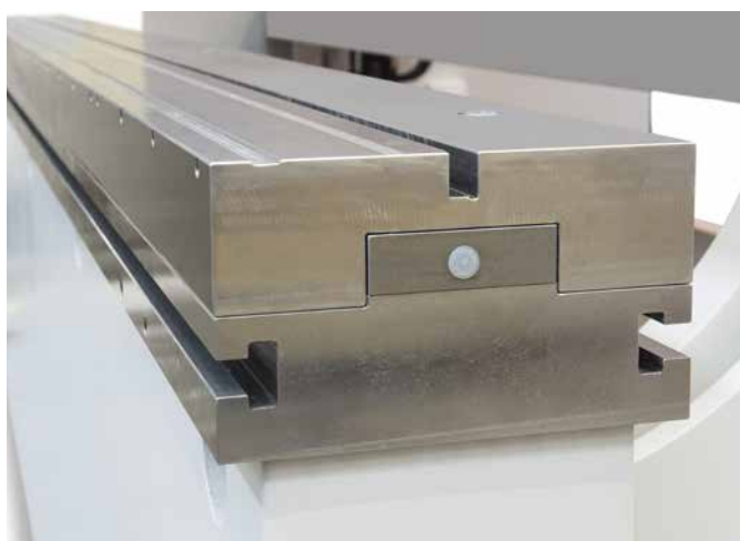
Szerszy stół do stosowania matryc multi-V
