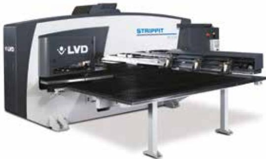
Diese Einzel-Kopf-Stanzpresse kann stanzen, umformen, biegen sowie gewindeformen
