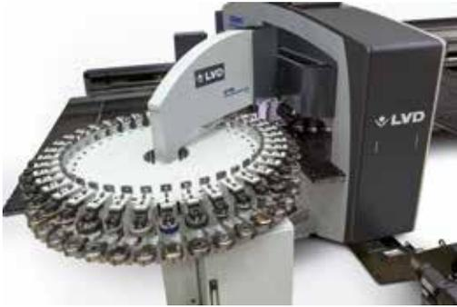
Zusätzliche Werkzeugkapazität und automatischer Werkzeugwechsel
