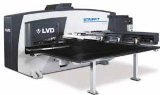
Punzonadora de cabezal único que puede perforar, deformar, doblar y roscar en una sola máquina
