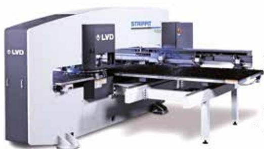
Poinçonneuse économique destinée à la production cellulaire et à la fabrication de petites séries
