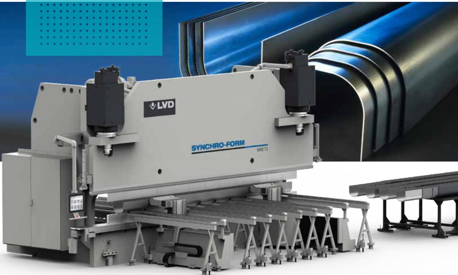
LVD entwickelt mit Synchro-Form ein bahnbrechendes, neues Lösungskonzept für die Umformung großer Profile mit mehrfachen Biegevorgängen. Dieses einzigartige System macht das Biegen großer Profile einfach, effizient und durchgängig präzise und eliminiert Versuchsbiegungen und akkumulierte Fehler. Synchro-Form bietet eine automatische Positionierung, automatische Messungen sowie Kompensation, sodass auch nach mehreren, aufeinanderfolgenden Biegevorgängen das Profil perfekt geformt wird.
